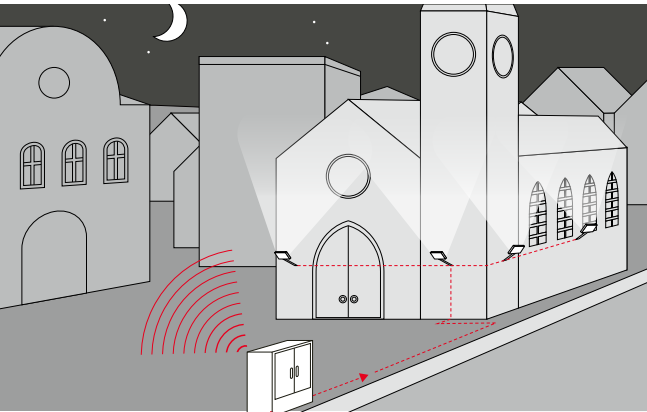
Gebäude-Anstrahlungen nach Uhrzeit an- und abschalten.
