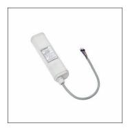
Street Light ControlSensor Coupler, Montageart: Einbau, Montageort: im Mast, aus PC, Schutzart (gesamt): IP54, Schutzklasse (gesamt): SK II (Schutzisoliert), Spannung: 230V, Spannungsart: AC, Anschlussleitung vormontiert, Leitungslänge: 0,5 m, 1 x LON-Powerline-Protokoll, 1 x 1..10V, 1 x DALI, 2 x Relaiskontakt, 1 x Steuerausgang, Verpackungseinheit: 1 Stück
