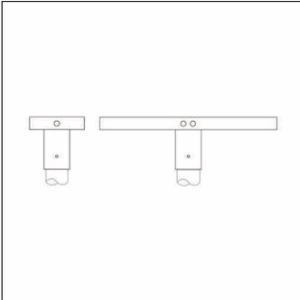
MAXI Fluter/Scheinwerfer, Baugruppe Montage, Traverse für 1 Fluter, aus Stahl, verzinkt, Typ 1: Aufsatz, Länge: 150 mm, Zopfmaß: 89mm, Verpackungseinheit: 1 Stück
