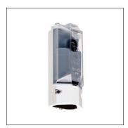
Kabelübergangskasten, für 1 oder 2 Kabel bis 5x 10mm², L1/L2/L3/N/PE, 1x E14, Kabelübergangskasten, aus Kunststoff, schlagfest, Mastinnendurchmesser: ab 70mm, Schutzart (gesamt): IP43, Schutzklasse (gesamt): SK II (Schutzisoliert), Prüfzeichen: CE, Verpackungseinheit: 1 Stück
